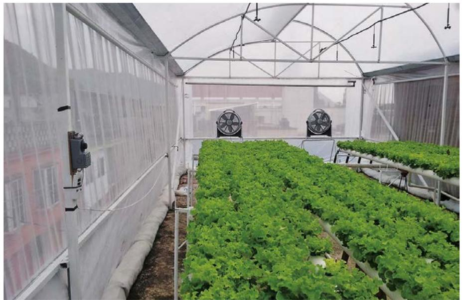
Figura 1. Sistemas de enfriamiento por nebulización y aire forzado, termostato.
