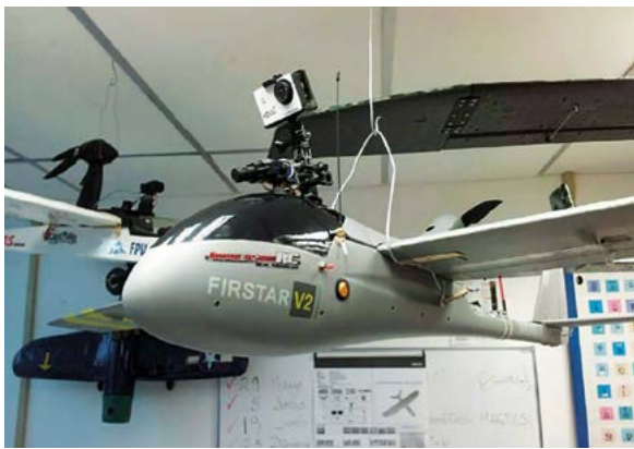
Modelo Raptor Firststar V2 de Volantex RC, con el sistema de piloto automático (ArduPilot 2.6)
