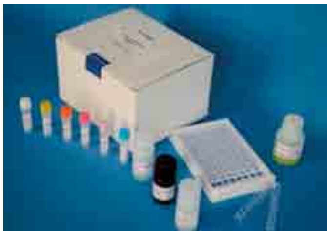
Figura 3. Kit de Ridascreen® para la determinación de clembuterol en carne de bovino.
