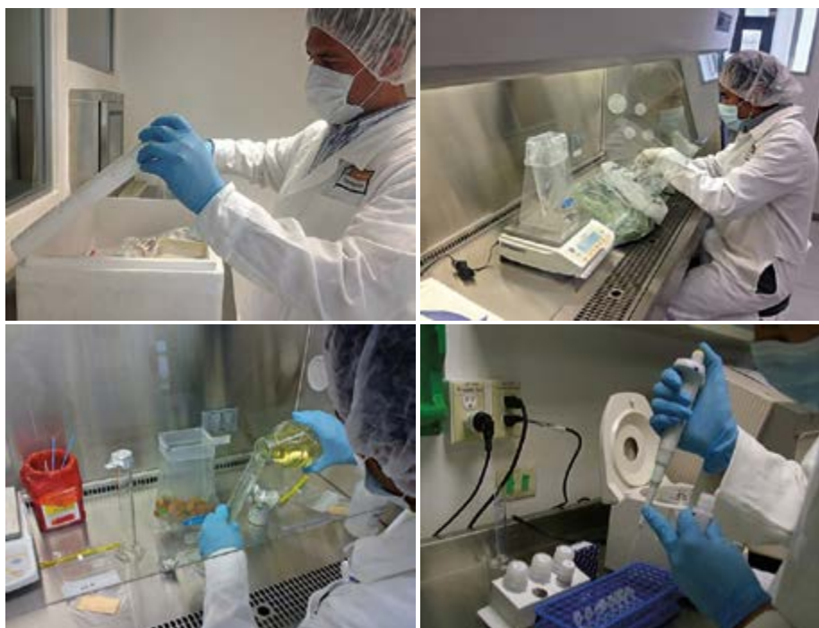
Figura 11. Registro e identificación de la muestra, preparación y homogenización de la muestra, enriquecimiento de la muestra, extracción de Ácidos Nucleídos del patógeno blanco, ejecución de la Reacción en Cadena de la Polimerasa o el Ensayo de Fluorescencia Ligado a Enzimas, interpretación de resultados y emisión de resultados presuntivos.
