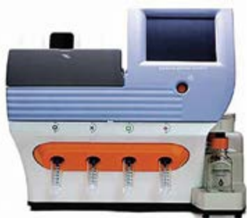
Figura 8. Equipo Ion Torrent que trabaja con un chip semiconductor que es utilizado para validar resultados del 454 GS FLX
