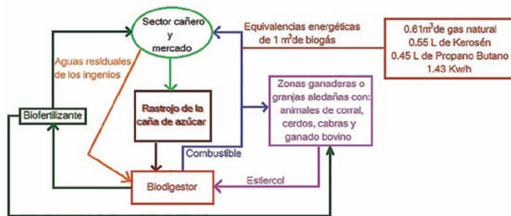
Figura 1. Sistema integral agrícola del manejo de residuos de caña de azúcar (rastrojo).
