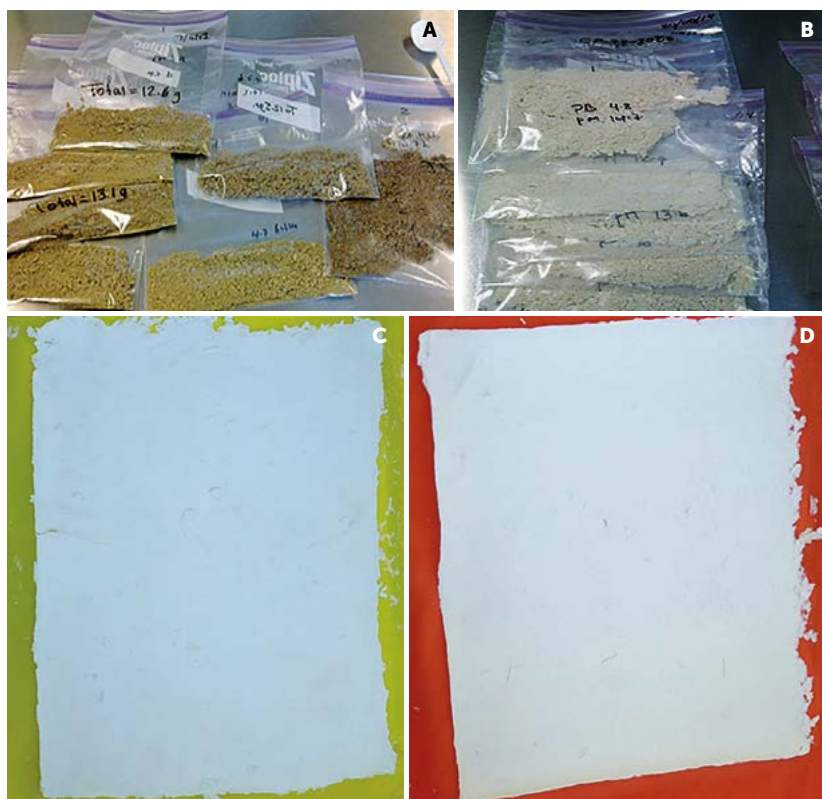
Figura 5. Materiales celulósicos. A: Fibra de celulosa. B: Pulpa de celulosa. C: Hoja de papel artesanal elaborado con pulpa de celulosa extraída con el método a la sosa. D: Hoja de papel artesanal elaborado con pulpa de celulosa extraída con el método artesanal.
