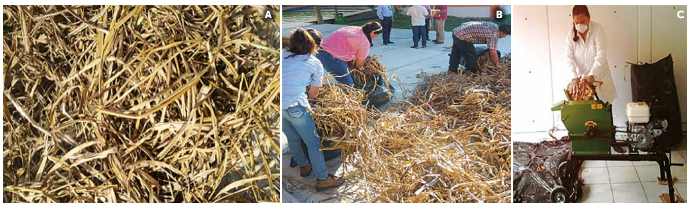
Figura 1. Procesamiento de paja de caña de azúcar para obtención de celulosa. A: Secado. B: Seleccionado. C: picado.
