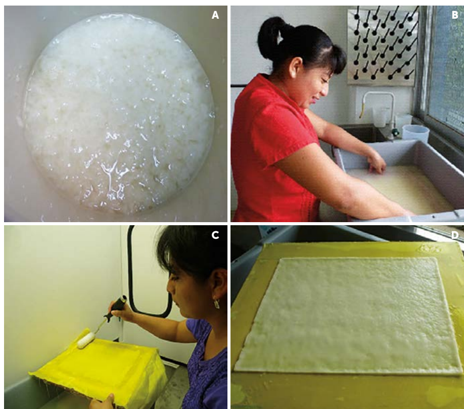
Figura 3. Proceso de elaboración de papel artesanal con fibra de celulosa blanqueada. A: Pulpa de celulosa hidratada. B: Formación de hoja. C: Eliminación de exceso de humedad. D: Hoja de papel húmeda.
